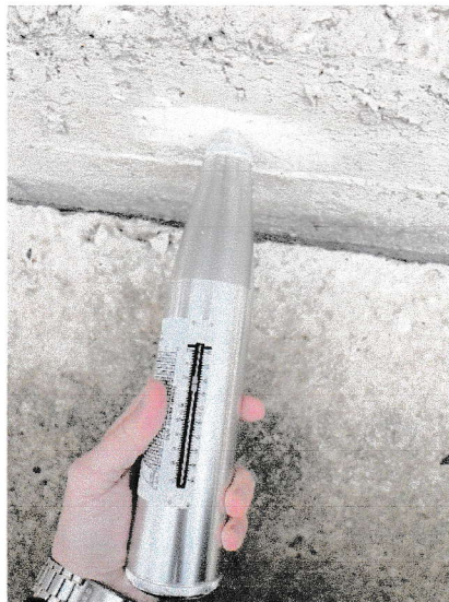
Նկ. 2 Բետոնի փաստացի ամրության որոշման դրվագ
